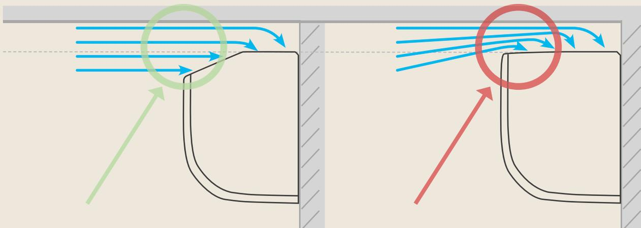
Даже при максимально близком расположении к потолку воздух свободно поступает во внутренний блок, без создания области турбулентности и высокого сопротивления воздуха, благодаря чему кондиционер работает в нормальном штатном режиме. Разрешенное расстояние всего 50 мм.
