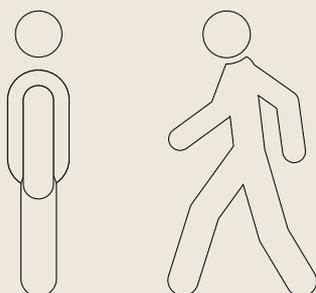
Датчик присутствия Eco Sensor постоянно контролирует наличие людей в помещении. Если в течение 20 мин. кондиционер не обнаруживает людей — уставка изменяется на 1 °С; через 40 мин. уставка изменяется еще на 1 °С.
