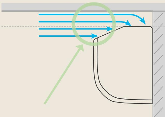
Даже при максимально близком расположении к потолку воздух свободно поступает во внутренний блок, без создания области турбулентности и высокого сопротивления воздуха, благодаря чему кондиционер работает в нормальном штатном режиме. Разрешенное расстояние всего 50 мм.
