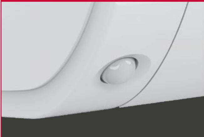
Датчик присутствия Eco Sensor постоянно контролирует наличие людей в помещении. Если в течение 20 мин. кондиционер не обнаруживает людей — уставка изменяется на 1°C; через 40 мин. уставка изменяется еще на 1°C.
