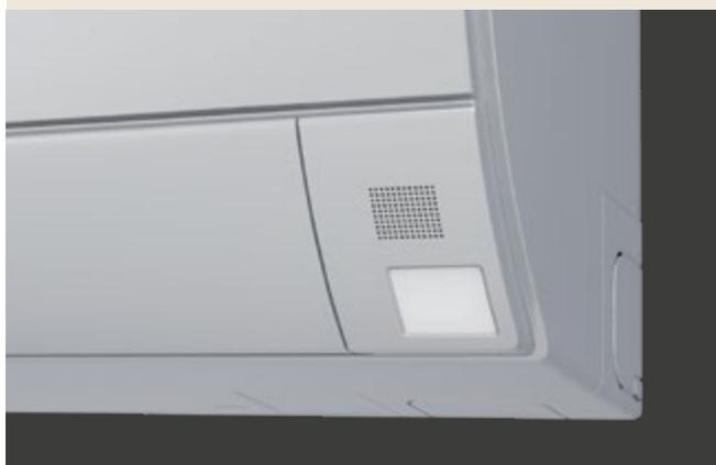
Датчик присутствия Eco Sensor постоянно контролирует наличие людей в помещении. Если в течение 20 мин. кондиционер не обнаруживает людей — уставка изменяется на 1°C; через 40 мин. уставка изменяется еще на 1°C.
