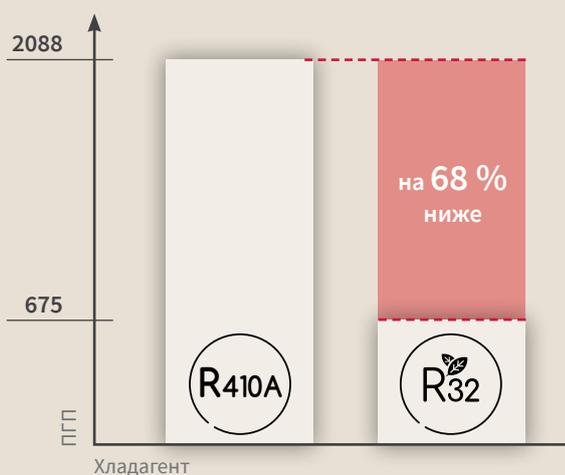
Хладагент нового поколения R32 имеет более высокую энергоэффективность, а также потенциал **воздействия на глобальное потепление в 3 раза ниже по сравнению с R410A**. При этом требуется значительно меньший объем заправки хладагента при равной производительности кондиционера.
